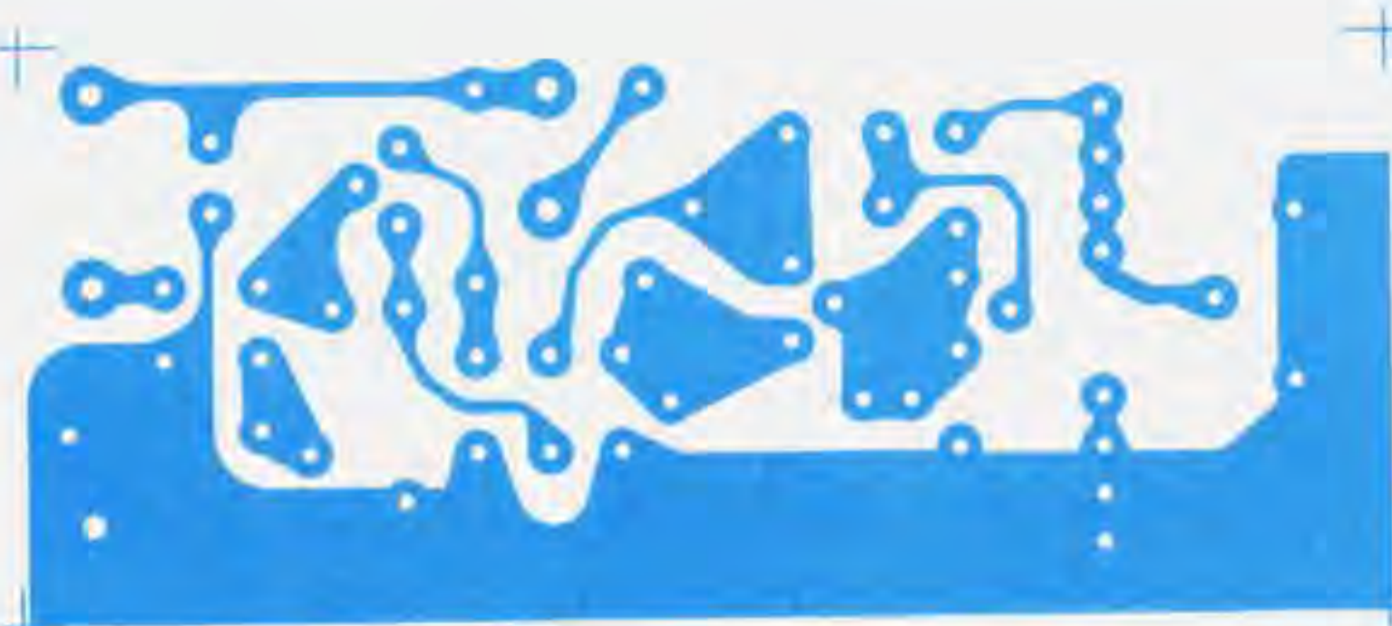
Fig.306 Disegno del circuito stampato, visto dal lato rame, dello stadio oscillatore di fig.299.
