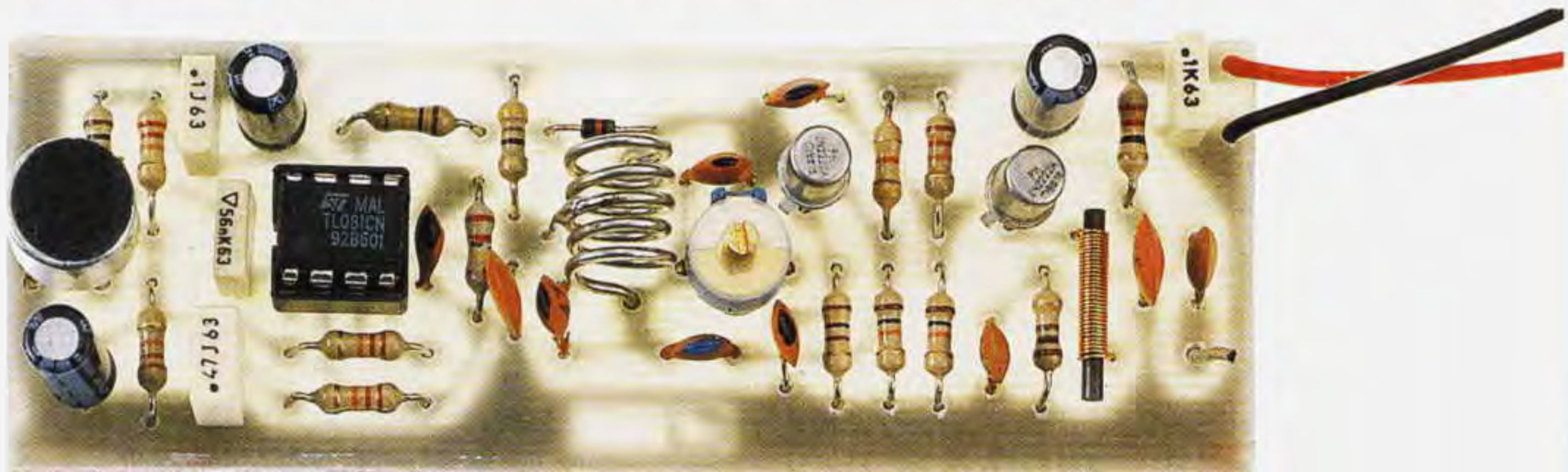
Fig.321 Foto del trasmettitore in FM. Il circuito stampato che vi forniremo risulta già forato e completo di disegno serigrafico. Per aumentare la portata, anziché utilizzare un'antenna lunga 73-74 cm, si potrebbe utilizzare un filo lungo 220 cm pari a 3/4 di lunghezza d'onda. Se userete lunghezze diverse, irradierete meno potenza.
