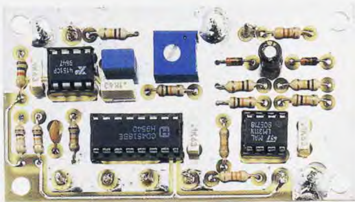
Fig.8 Come si presenta il convertitore Frequenza/Tensione a montaggio ultimato.
