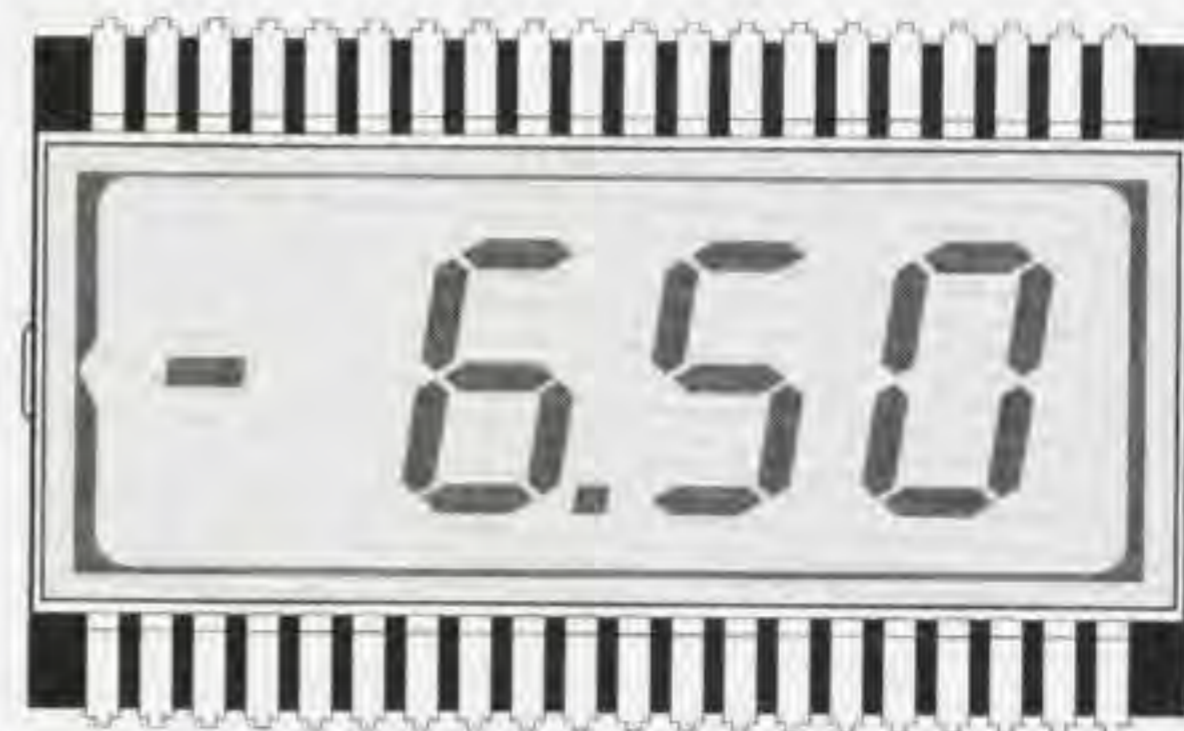
Fig.12 Spostando il deviatore S3 in posizione Audio , sul display LCD viene visualizzata la frequenza della portante Audio .
