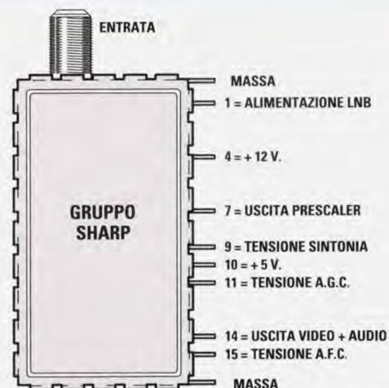
Fig.2 Le connessioni dei 10 terminali che fuoriescono dal Tuner Sharp. I due terminali contrassegnati "massa" sono direttamente collegati allo schermo del Tuner.
