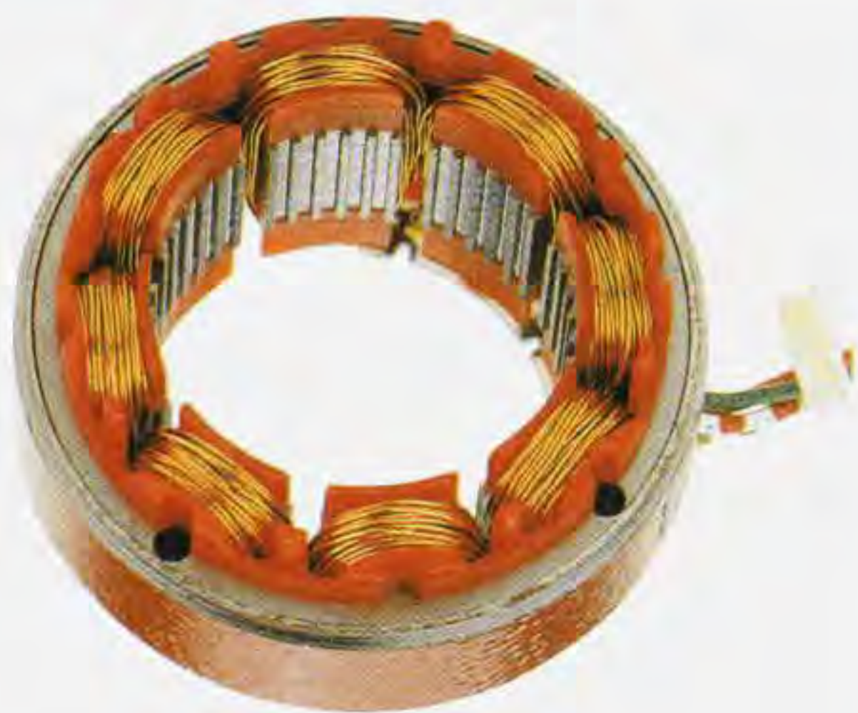
Fig.1 Se apriamo un motore passo-passo potremo vedere al suo interno tutte le bobine eccitatrici che serviranno a far ruotare il rotore visibile in fig.2.
