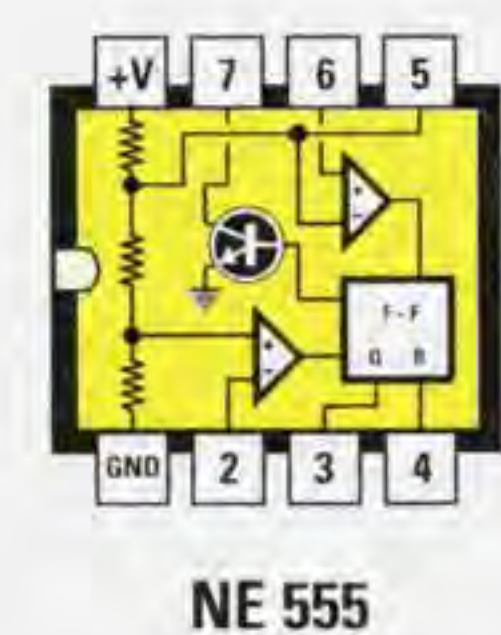
Fig.16 Connessioni dell'integrato NE.555 viste da sopra e con la tacca di riferimento ad U rivolta verso sinistra.
