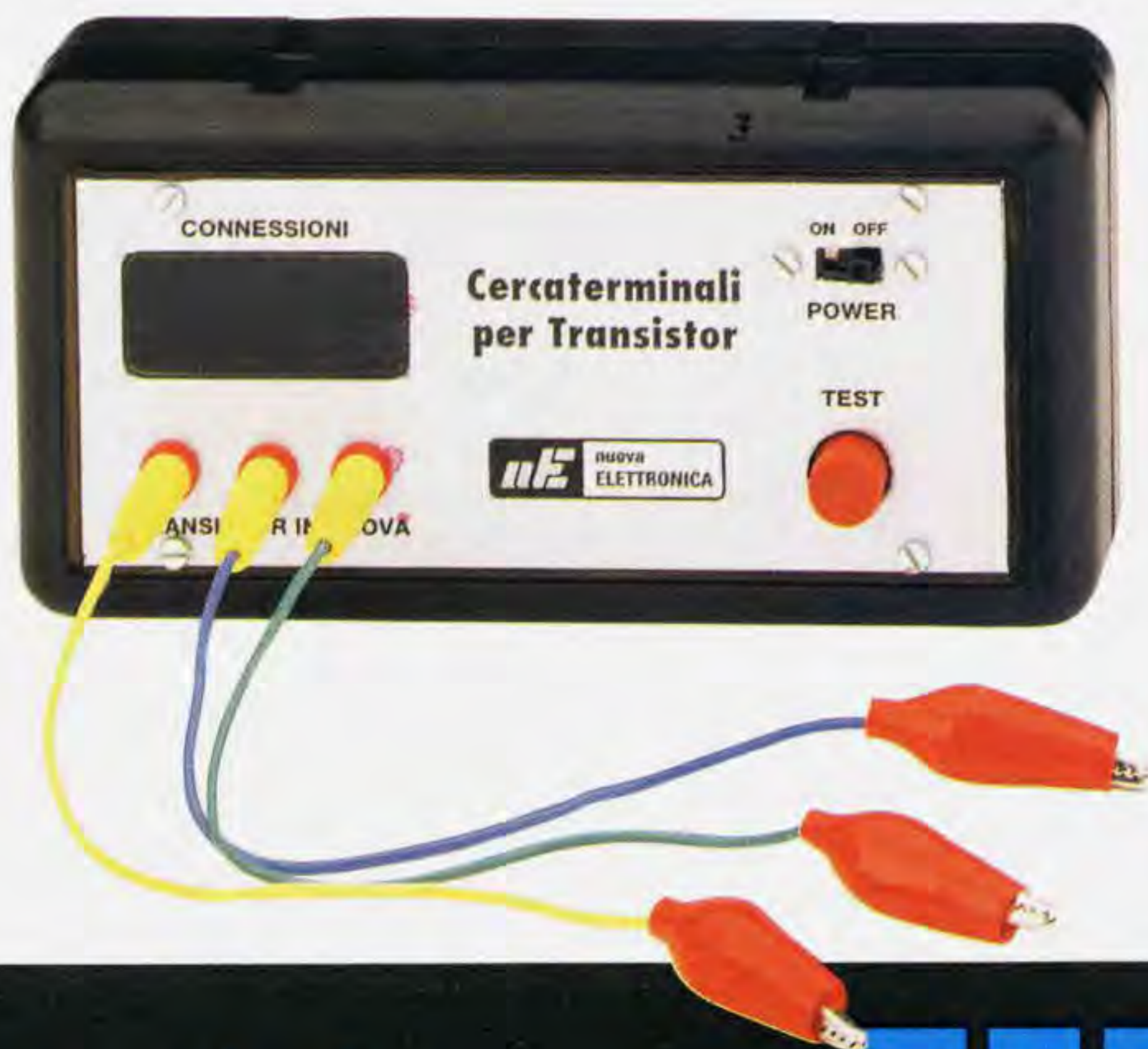
Fig.1 Questo circuito vi permetterà di individuare velocemente come risultano disposti i terminali E-B-C in un transistor e anche di sapere se è un PNP o NPN. Se il transistor sotto test è difettoso, sui display vedrete apparire la scritta "bAd".
